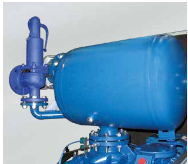
无吸音材料的消音器具有诸多好处
