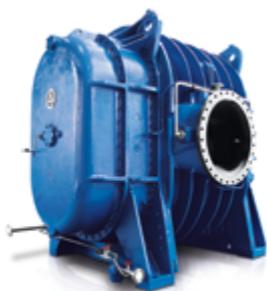
Eje libre soplador (mono etapa o doble etapa) para plantas industriales con sistemas de transporte de gases de proceso y refrigerantes. Dirección de caudal horizontal. Sistema de lubricación por recirculación de aceite. Adecuado para inyección continua de agua para refrigeración y purificación. Disponible en 6 tamaños para rangos de presión positiva hasta PN 6. Delta P posible hasta 1.500 mbar.
