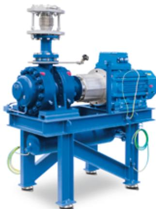
Eje libre soplador de transmisión directa (mono etapa o doble etapa) para transporte neumático libre de aceite. Sistema independiente de lubricación por recirculación. Opcionalmente en versión de acero inoxidable o en versión especial con propulsor de acetileno según norma TRAC. Delta P posible hasta 2.000 mbar.
