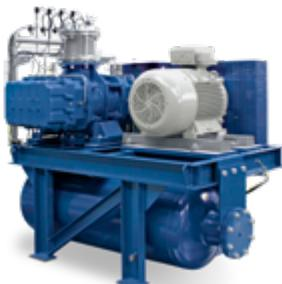
Eje libre versátil (mono etapa o doble etapa) para la fabricación de sistemas de transporte neumático verticales y libres de aceite. De transmisión directa, con caja de engranajes o transmisión por correa. Opcionalmente disponible con inyección de líquidos para refrigeración o purificación de gases. Disponible en 12 tamaños para casi todos los gases técnicos y gases mixtos. Delta P hasta 1.500 mbar posibles.
