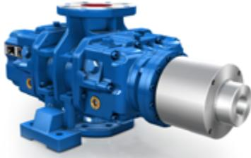
Búster de aplicación universal personalizable con acoplamiento magnético para el transporte libre de aceite. Concepto de sellado de bajo mantenimiento, la separación entre el aceite y el lado del proceso se logra mediante un sello especial de anillo de pistón. Presión de diseño de 7 bar (g) según AD2000 / DIN EN 13445. Disponible en 16 tamaños.
