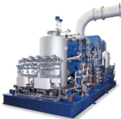
Equipo compresor (mono etapa o multi etapa) para comprimir gases de proceso (salvo O<sub>2</sub> y Cl). Compresión libre de aceite. Diferentes tipos de transmisión: directa, con engranaje cilíndrico con brida o independiente. Diseñado para cumplir con normas internacionales como API o con las especificaciones del cliente.
